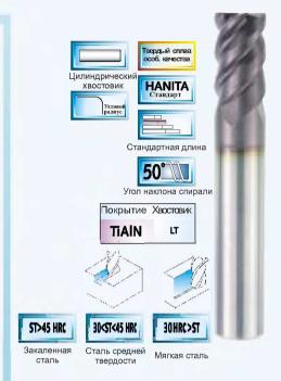
Многозубая фреза с плоским торцем, утолщенной сердцевиной, угловой радиус, укороченная, для фрезерования периферией твердых сталей.
