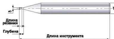
для обработки деталей малого размера **2-Х ЗУБАЯ, ПЛОСКИЙ ТОРЕЦ | СВЕРХДЛИННАЯ ШЕЙКА, МАЛЫЙ ДИАМЕТР**
